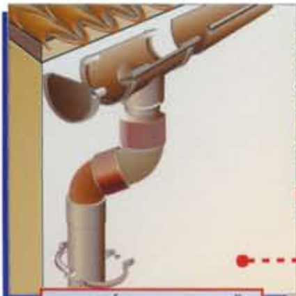
CANALÓN DE DESAGÜE
